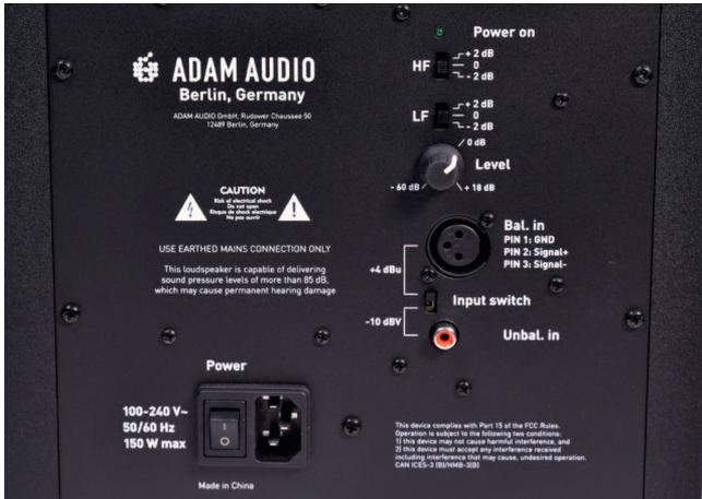
Bedienelemente auf Rückseite mit HF- und LF-Filtern zur Ortsanpassung und einem Poti als Gain-Steller
