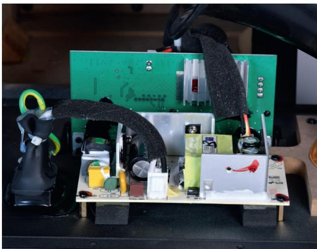
Die kompakte Elektronik im T8V: vorne das Netzteil und dahinter die Endstufen- und DSP-Platine
