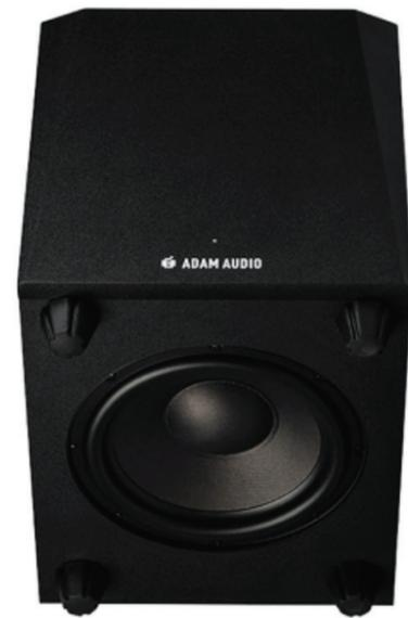
La disposizione "down-firing" (verso il basso) del sub fa preferire un taglio del crossover sugli 80 Hz perché impostando i 120 Hz si percepisce una lieve perdita delle frequenze più elevate che non sfruttano l'omnidirezionalità propria di quelle più basse. Però, la vicinanza dello speaker al pavimento amplifica l'effetto vibratorio.
