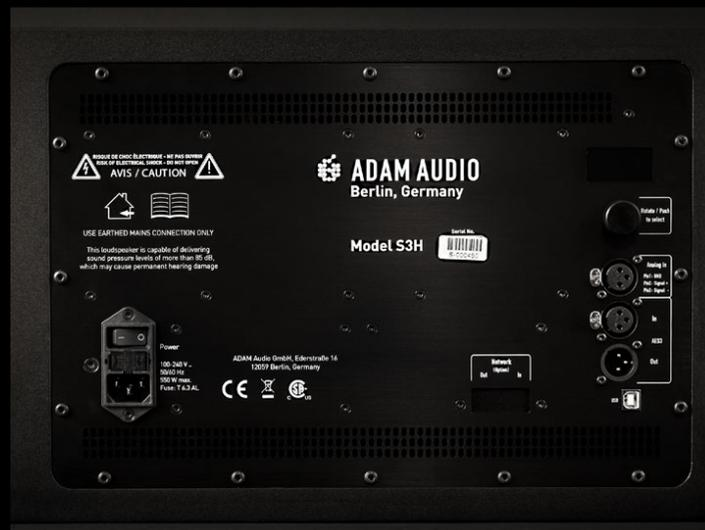
Auf der Rückseite finden sich sämtliche Anschlüsse sowie der Druckgeber/Drehregler plus Display für die Navigation.
