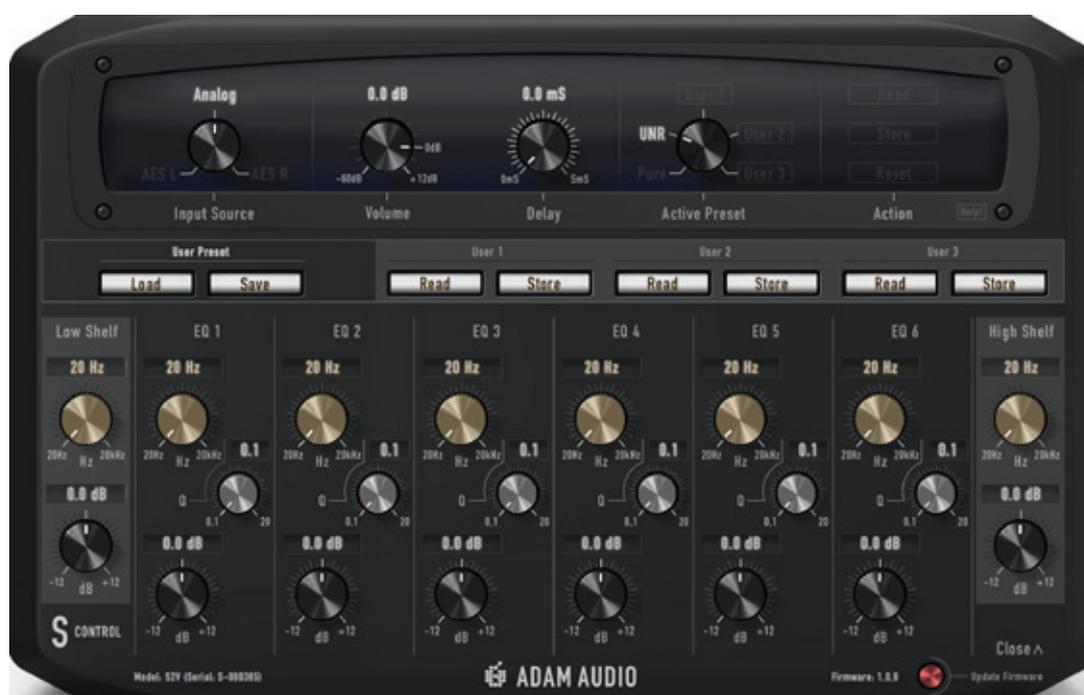
如果需要详细地编辑用户自定义的预设，可以单击初始界面右下角的“OPEN v”按钮来展开编辑界面。[如上图]可以在这个界面分别调节任意频率范围的EQ均衡，一共有六段，另外还可以旋转中间的旋钮来调整相应的Q值，来控制影响的范围；高频/低频搁架滤波均衡也可以在这个页面进行调节。其中的每一个参数都对应一个旋钮，可以用鼠标来旋转调节，也可以直接单击相应的数值，用键盘输入具体的数字。
