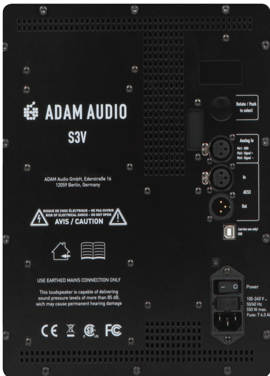
Über den hinten befindlichen USB-Port lassen sich Firmwareupdates installieren und DSP-Funktionen fernsteuern.
